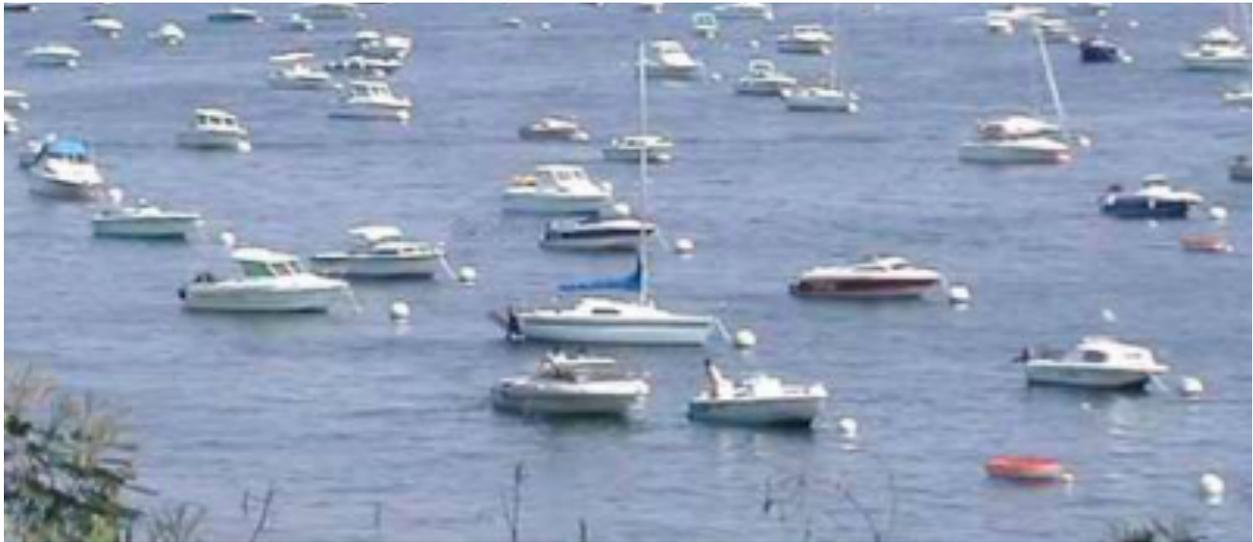
Un **corps-mort** sert au stationnement près du rivage d'un bateau qui n'a pas de place dans un port. Il est généralement constitué d'une dalle de béton posée au fond de l'eau, reliée à une bouée par une chaîne, le dispositif étant déposé à l'automne et réinstallé au printemps.
