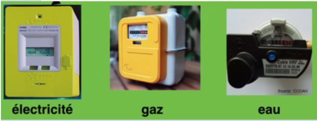
Certains de ces compteurs, selon les opérateurs, utilisent diverses fréquences radio, mais la particularité du compteur Linky est d'utiliser la technologie CPL= Courant Porteur en Ligne. Il utilise donc les lignes électriques de votre maison pour transmettre des signaux. Il est déjà utilisé en domotique et en informatique, parfois sans que vous le sachiez, sur votre lieu de travail. Dans votre maison si vous avez
