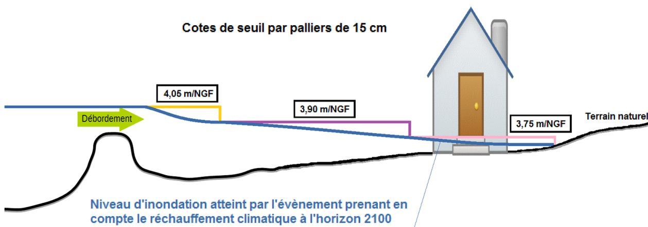
Illustration 13 Coupe schématique des cotes de seuil sur le terrain
